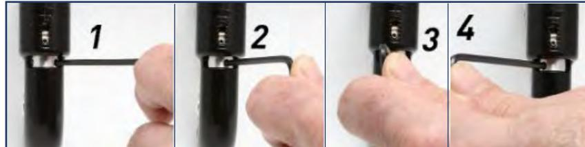
*Insérez la clé BTR dans le trou de droite et utilisez la clé comme levier pour tourner la bague vers la gauche du nombre de mouvements indiqués dans le tableau. Les étapes 1 à 4 ci-dessus représentent 1 mouvement.*
