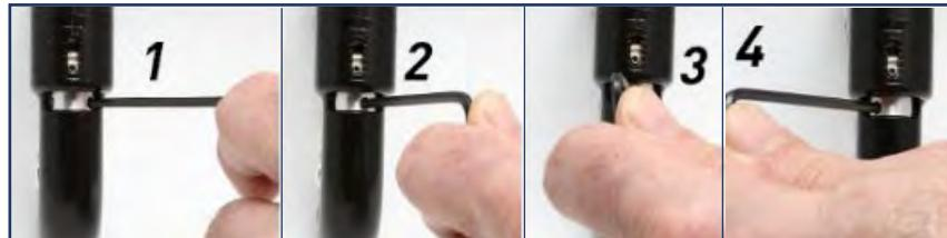
Inserire l'estremità della chiave a brugola nel foro a destra e usare la chiave a brugola come leva per ruotare il regolatore di potenza finché il foro a destra si è spostato a sinistra. Ripetere per ogni movimento. I passi da 1 a 4 qui sopra rappresentano 1 movimento.
